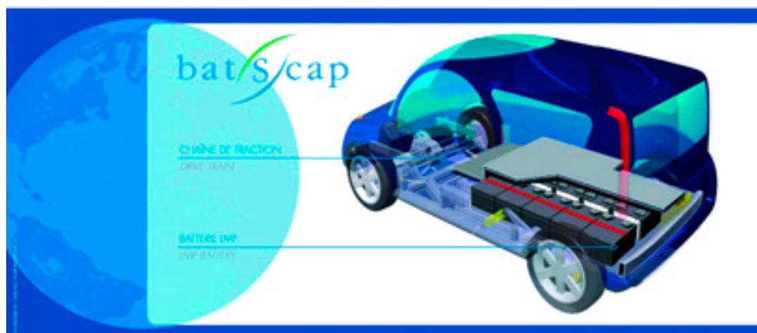
La batterie de faible hauteur répartie sous le plancher n'occupe que peu d'espace et abaisse considérablement le centre de gravité garantissant ainsi maniabilité et stabilité. Le faible encombrement du moteur électrique et de son réducteur (pas de boîte de vitesses) a permis de réaliser des zones de déformation conformes aux normes européennes tout en gardant une réelle compacité.
